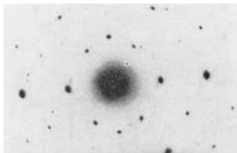
Fig. 9. Feinbereichs-Elektronenbeugung eines sehr engen ausgeblendeten Ausschnitts eines zu  $Mn_3O_4$  reduzierten Manganan(III)-manganat(IV)-Plättchens
